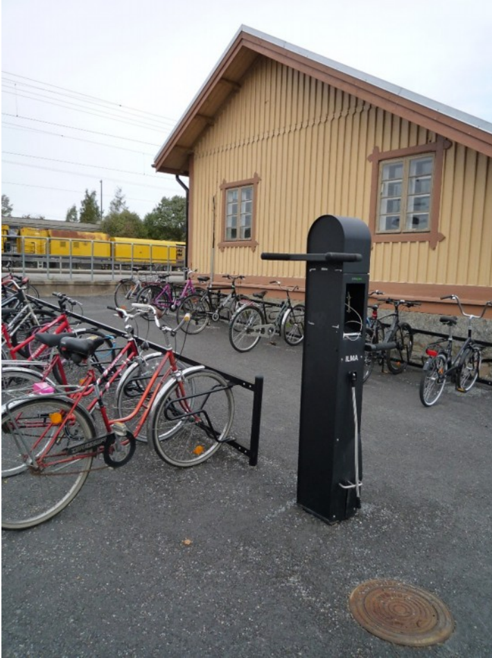
Kuva 37 Esimerkki polkupyörien huoltotolpasta Vammalan rautatieasemalta Sastamalasta 2018. Tolppa sisältää pyörän kannatintelineen, vajerilla kiinnitetyt työkalut ja jalkakäyttöisen ilmapumpun.
