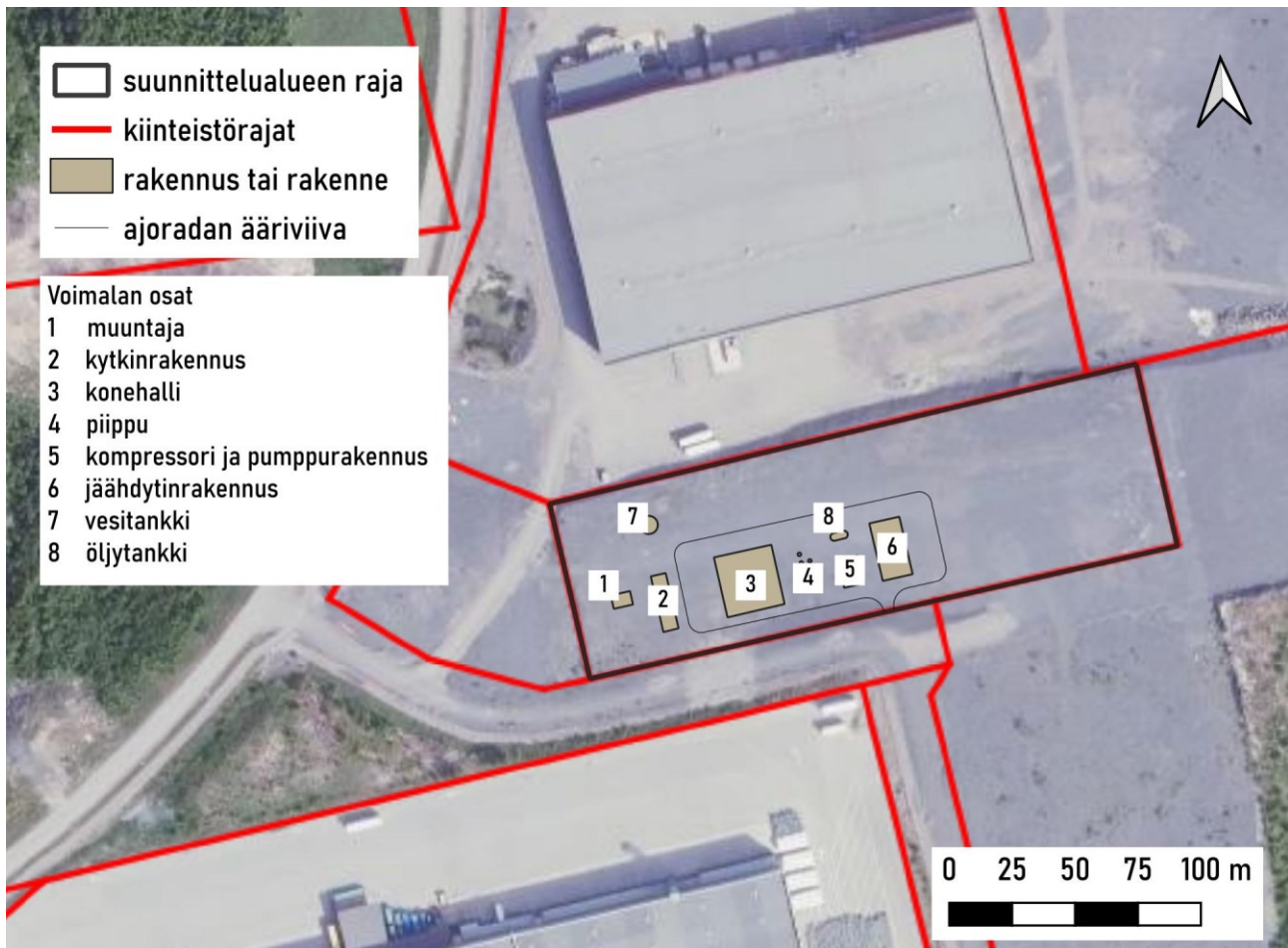
KUVA 4.2 KUVASSA ESITETTY VOIMALAITOKSEN OSAT PERIAATETASOISESTI
