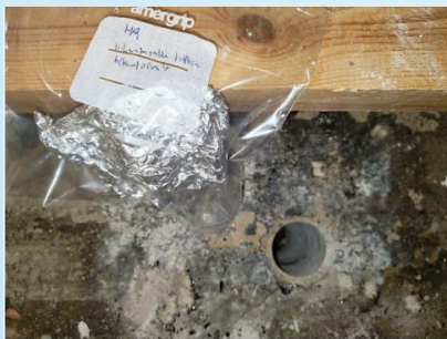
Kuva 15. 001, bitumisivelyt lattian betonilaatan päällä ei sisällä asbestia (HA11)
