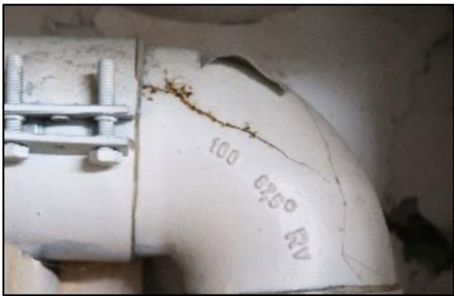
Ison liikuntahallin varasto. Pystyviemärin haarakappaleessa ilmeni vakava halkeama ja reikä. Oikealla kuvasuurennos vikakohdasta.
